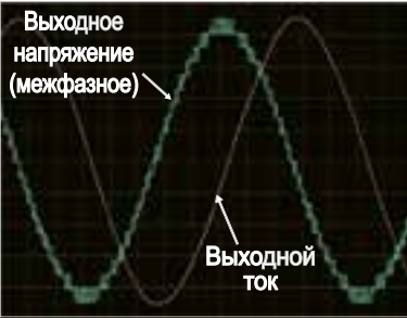
Кривые тока и напряжения на выходе для ПЧ 6 кВ
