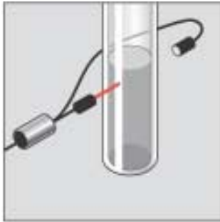
BOS 18M-...-1PD-... Diffuse BFO 18A-... Fiber optics
